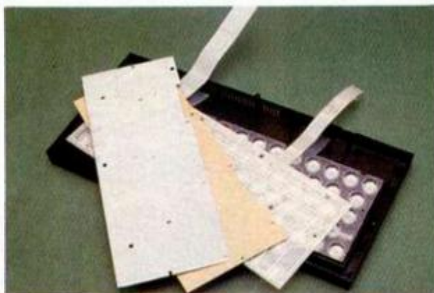
Las cuatro capas que constituyen el teclado.
